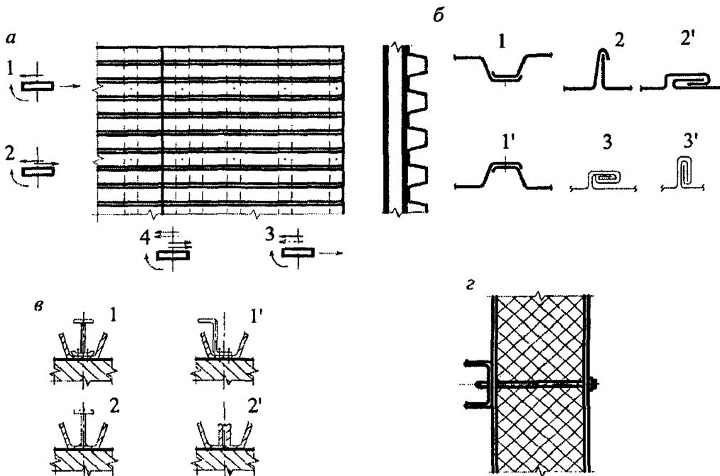
а - фрагмент конструкции покрытия со стальным профилированным настилом и схема действия сил на опорах
