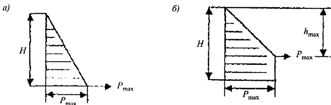
a - гидростатическое давление; б - расчетное давление
